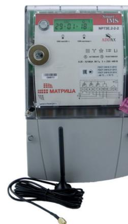
Счетчик электрической энергии трехфазный четырехпроводный прямого включения со встроенным GPRS-модулем предназначен для измерения активной и реактивной электрической энергии в прямом и обратном направлении в сетях переменного тока. Для приема и передачи данных используется канал GPRS.
