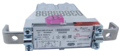
Счетчик электрической энергии NP523, оборудованный отключающим реле, предназначен для учета потребления активной электрической энергии в однофазных цепях переменного тока и отличается тем, что закрепляется непосредственно на проводах электросети. Это позволяет ограничить доступ абонента к прибору учета. Корпус счетчика обладает степенью защиты IP54.
